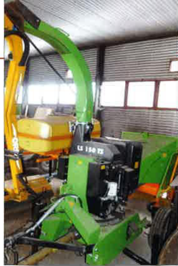
Jemná dezintegrace – štěpkovač LASKI LS 150 TS (energetický zdroj – vývodový hřídel, 25 kW, max. průměr dřevního odpadu – 160 mm, pracovní výkon 7–12 m 3 /h)
