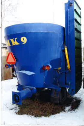
Promíchávání a homogenizace surovin – mobilní kompostárna Cernin MK 9 (energetický zdroj – vývodový hřídel, 25 kW, objem pracovního prostoru 9 m 3 , výkonnost 9–15 m 3 /h závisí na vlastnostech zpracovávaných surovin)
